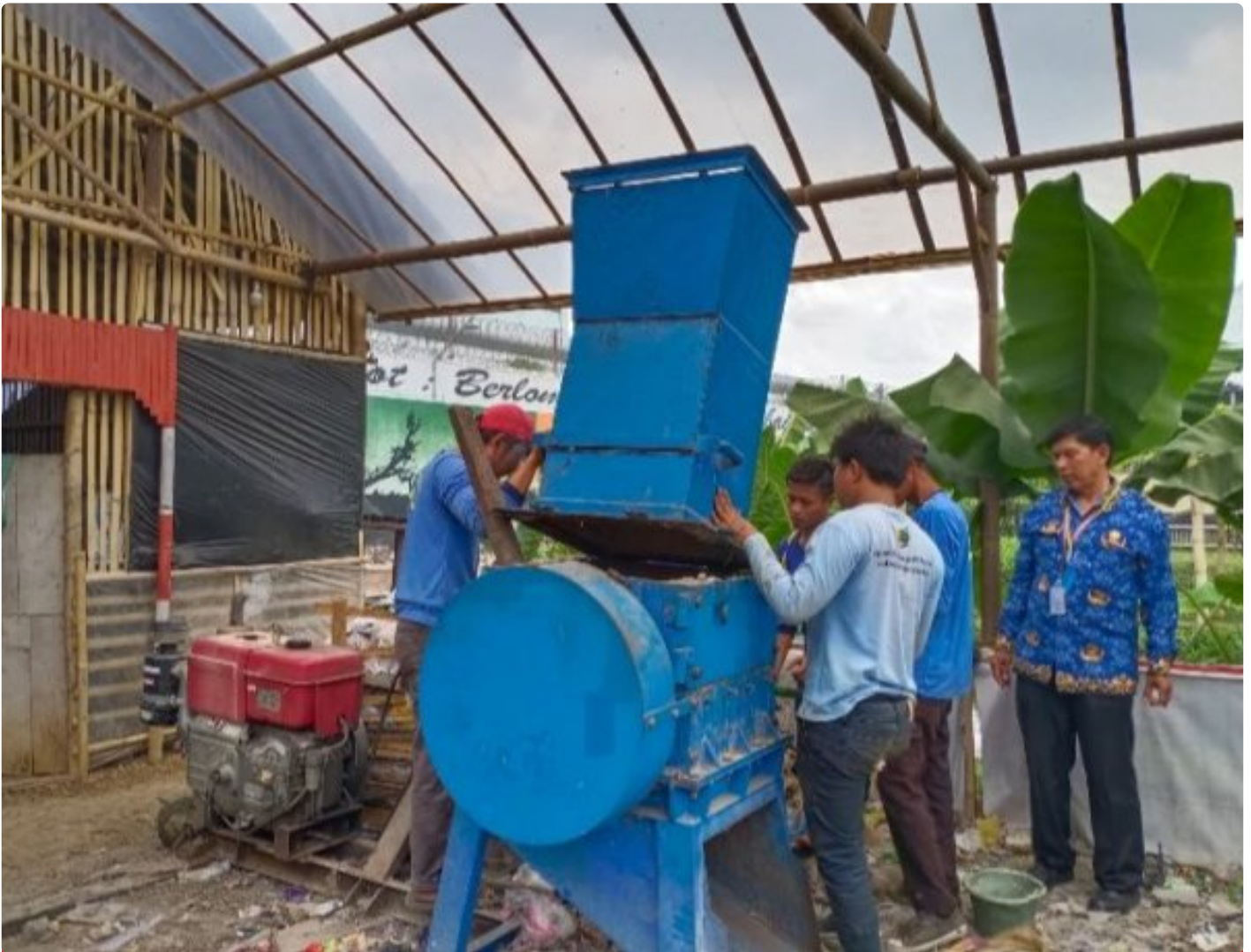
Mesin Cacadh Plastik Lola Sahdu, Perawatannya untuk Keberlanjutan dan Efisiensi Operasional Pengelolaan Limbah Plastik
